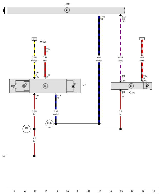
雨水与光线识别传感器, 车载电网控制单元, 自动防眩车内后视镜
