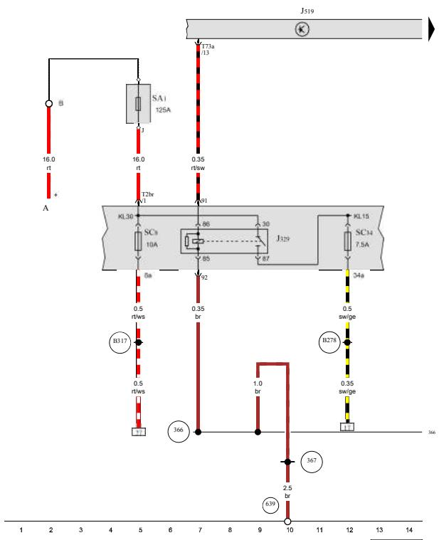
**接线端 15 供电继电器, 车载电网控制单元**
